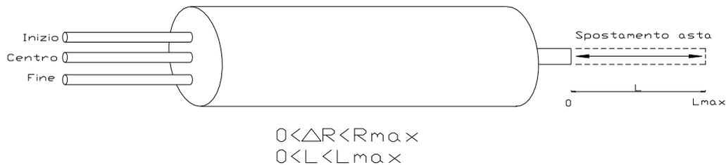
La resistenza del sensore è misurata tra l'inizio e centro e varia tra  $0[\Omega]$  quando l'asta è nella posizione  $L=0$ , ad un valore massimo  $R_{MAX}$ , dipendente dalle caratteristiche del sensore, quando l'asta è nella posizione  $L=L_{MAX}$  (asta tutta esterna)
